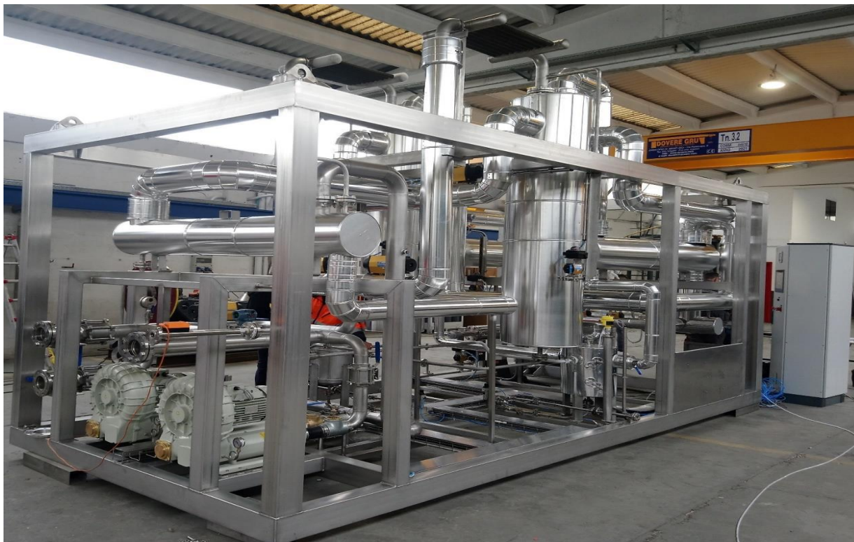
Figura 2.6: Esempio di impianto a condensazione
