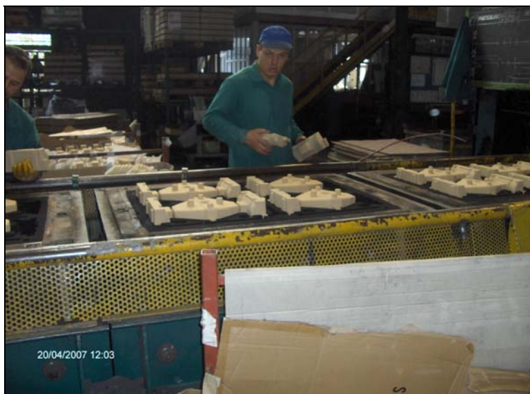
Fig. 1: Inserimento delle anime nelle forme della linea RH (20.04.07)
