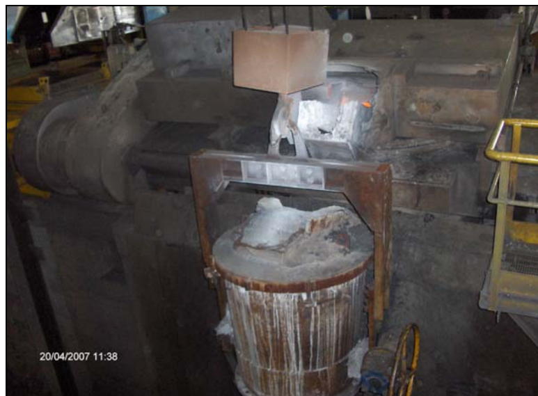
Fig. 2: inizio del trasferimento della ghisa fusa dal forno fusorio alla siviera, che la porterà al forno di colata (20.04.07)
